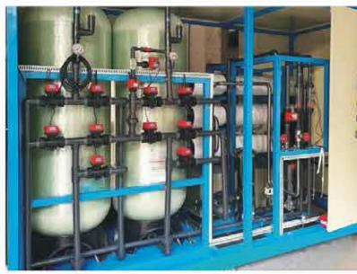
超纯水处理系统 Ultrapure water treatment system
